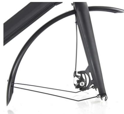
4. Fixer les freins à disque avant à l'aide des six vis intérieures du support de frein à disque de la fourche avant. L'installation peut se faire selon deux méthodes : montage radial et montage axial..
