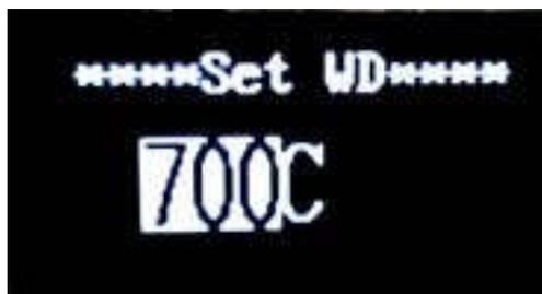
Interface des réglages de diamètre des roues
