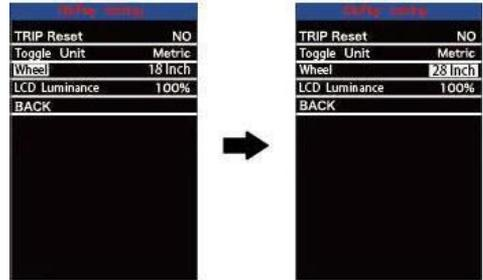
Interface du réglage du diamètre des roues
