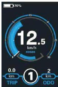
Interface de l'indicateur de la puissance du moteur
